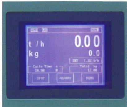
L'impiego di un display grafico del tipo touch-screen rende l'interfaccia con l'operatore estremamente intuitiva e razionale. Con poche e semplici pressioni sui tasti virtuali si possono impostare i principali parametri di funzionamento e rilevare le eventuali anomalie.
